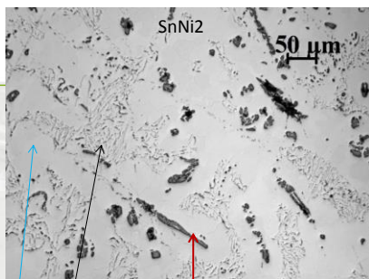
β-ón (β+Ni 3 Sn 4 ) Ni 3 Sn 4 1 °C/min fűtési – hűtési sebesség Ni 3 Sn 4 (β+Ni 3 Sn 4 ) β-ón
